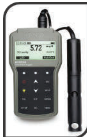
Fig. 2.2 Instrument portabil de măsurare a oxigenului dizolvat, și a temperaturii
