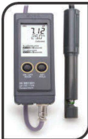
Fig. 2.1 Instrument portabil de măsurare a pH-ului, conductivității, cantității de suspensii și a temperaturii
